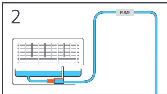
После того, как уровень конденсата в водозаборном резервуаре достигает отметки включения, насос включается. Во время заполнения подающей трубки, происходит некоторый нагрев насоса, так как в это время насос еще не смазывается и не охлаждается откачиваемым конденсатом.
