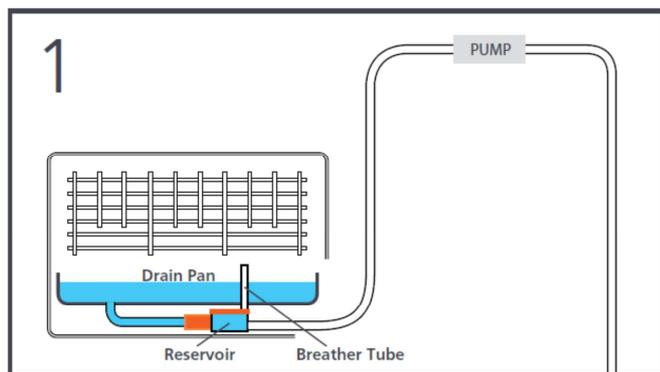
При первом запуске насоса, трубка, соединяющая водозаборный резервуар и насосную группу, заполнена воздухом.
