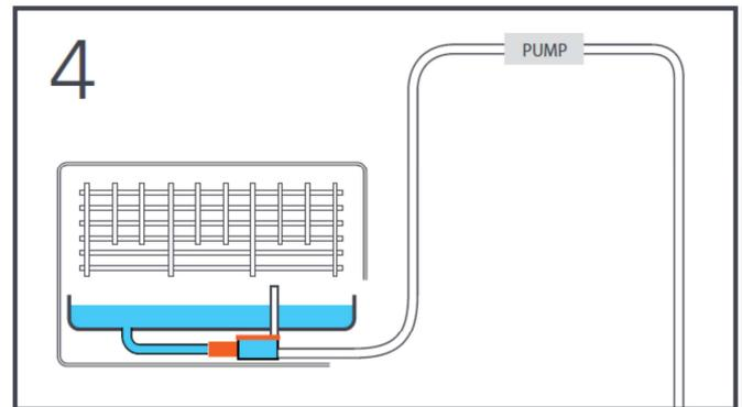
При повторном увеличении уровня конденсата в водозаборном резервуаре, цикл повторяется. Насос снова стартует «насухую».
