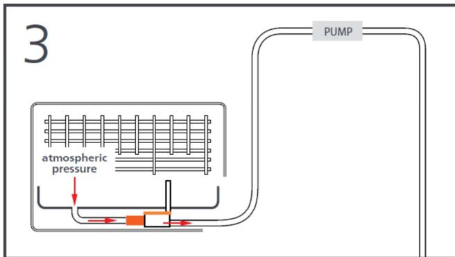
При снижении уровня конденсата в водозаборном резервуаре ниже минимального уровня, насос отключается. Но, в результате возникновения сифонного эффекта, вода продолжает покидать систему (выбросная трубка, насос, подающая трубка, резервуар) до полного ее опорожнения.
